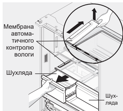
Видалення мембрани автоматичного контролю вологості
